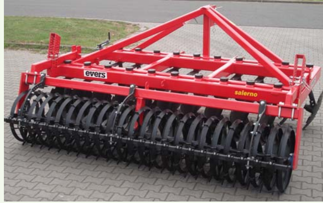
Het basis-model heeft verenstalen uitruimers en verstelbare stalen uitruimers aan de achterzijde van de rol
