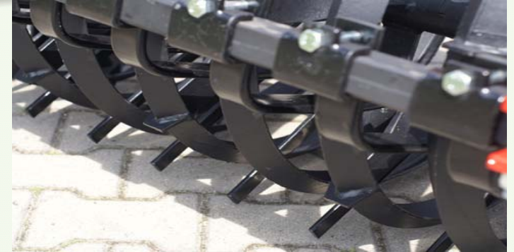
Het basis-model heeft verenstalen uitruimers en verstelbare stalen uitruimers aan de achterzijde van de rol
