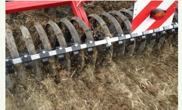
Het basis-model heeft verenstalen uitruimers en verstelbare stalen uitruimers aan de achterzijde van de rol
